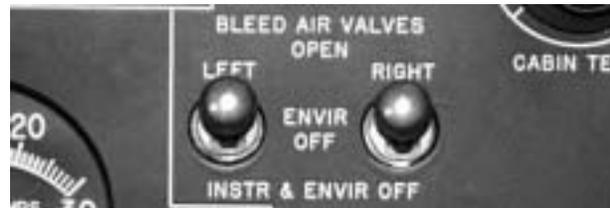
**Figure 1-9. Bleed-Air Valve Control**
