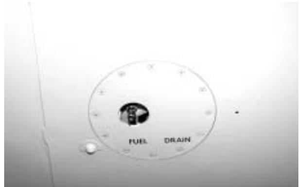
**41. AUXILIARY FUEL TANK SUMP—DRAIN**
