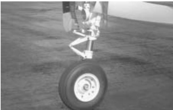
**46. NOSE GEAR, DOORS, STRUT, TIRE—CHECKED**
