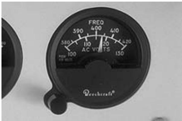
Figure 2-19. Volt-Frequency Meter
