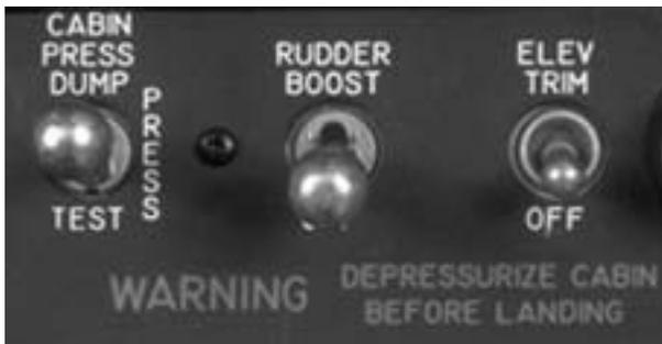
**Figure 12-9. CABIN PRESSure Switch**
