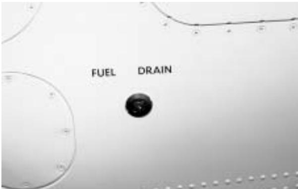
**10. FLUSH OUTBOARD DRAIN—DRAIN**
